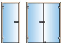
Jednokřídlové + zárubňa    Dvojkřídlové + zárubňa
